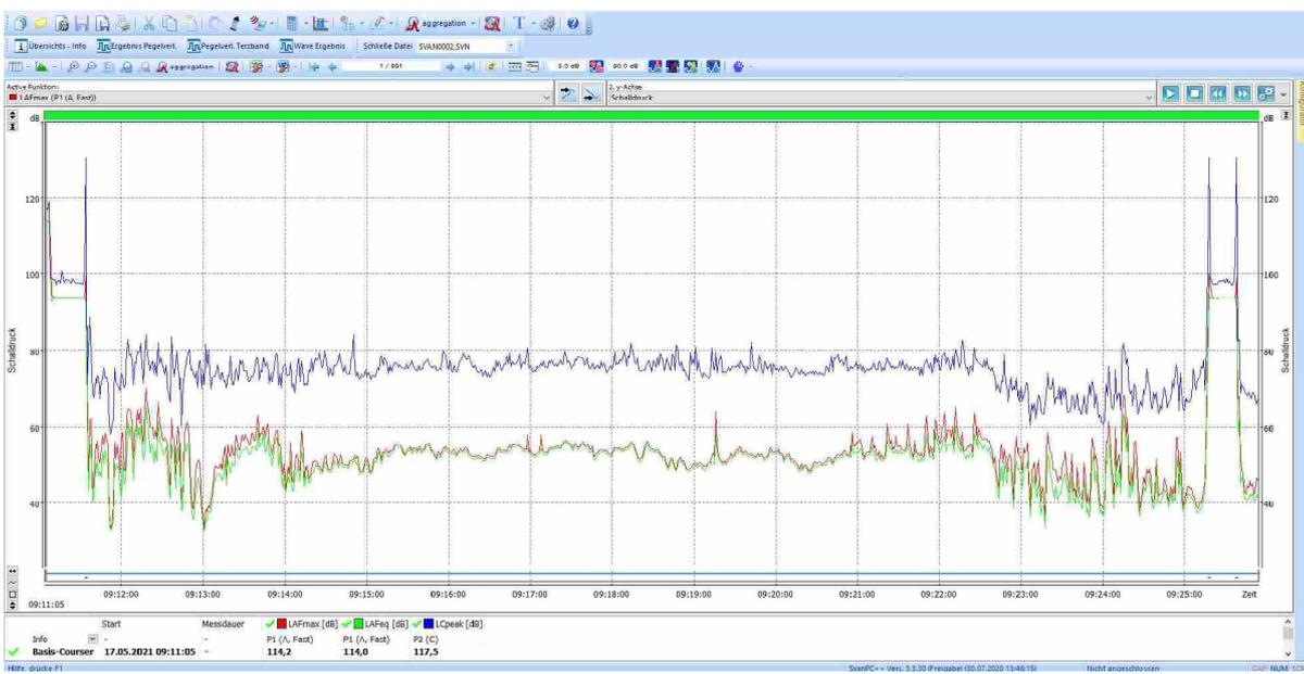
**Pegelzeitverlauf vom 17.05.2021 ca. 9.10 Uhr bis ca. 9.25 Uhr am Messpunkt IO 01**
